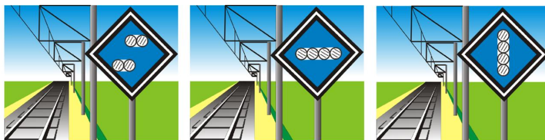
Знак “Подготовиться к опусканию токоприемника”
