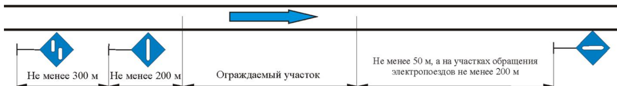
Схема установки временных сигнальных знаков об опускании и поднятии токоприемников
